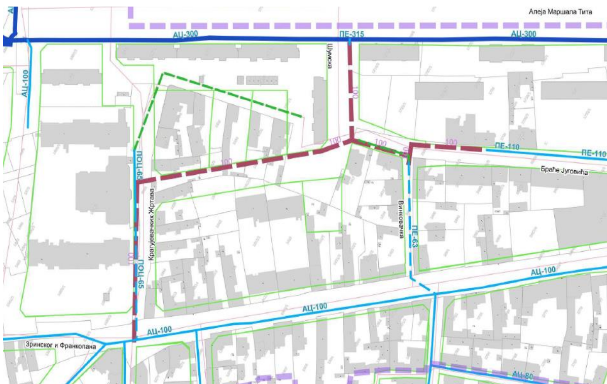
Slika 2 – Izvadak iz Uvjeta I2-216/2022 – prilog 2; tamno plave crte – magistralni vodovod, svijetlo plave crte – distribucijski vodovod tamno zelena crta – grupni priključak smeđa crta – nedostajući distribucijski vodovod promjera 100 mm povezan u prsten
